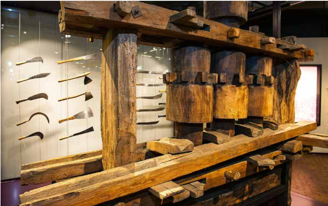
Südamerikanische Dreiwalzen-Zuckerrohrmühle in der Ausstellung, im Hintergrund die Vitrine mit Macheten und anderen Hackwerkzeugen.
